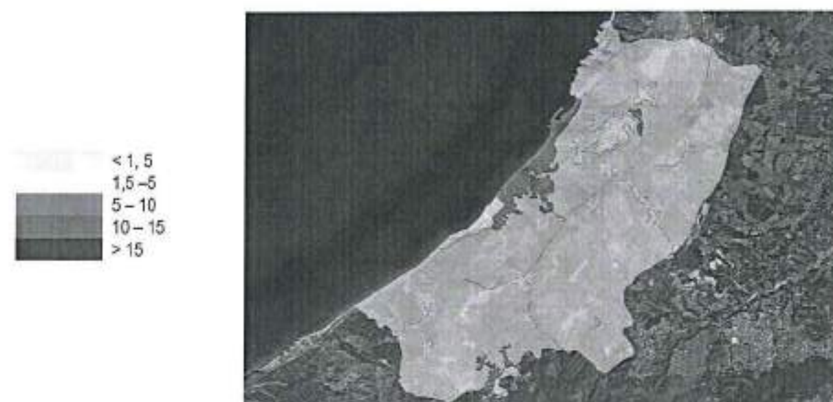
Figura 21. Distribuzione spaziale, per sezione censuaria, dei livelli di danno ( \geq 3 ) attesi su Bagnara Calabria in caso di sisma di riferimento (Intensità EMS-98 pari a 9)
